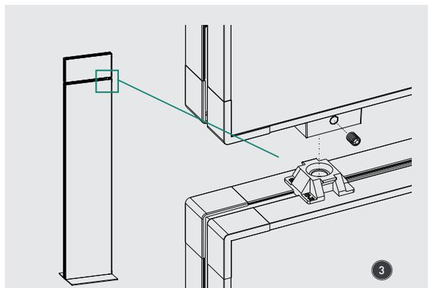
Modular wird ihr Ipoint mit dem Ipoint Connector. Vor der Montage einfach die Nutsteine einschieben und schon können mehrere Elemente ganz einfach verbunden werden.
