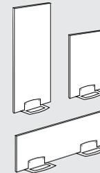
Flexible Höhen und Breiten: Maximalmaße hängen - bei Beachtung der Traglast - nur von der Steifigkeit des verwendeten Plattenmaterials ab.
